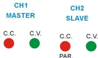
CH2(-)-COM CV/CC 状态请注意 CH2(Slave)指示灯。
