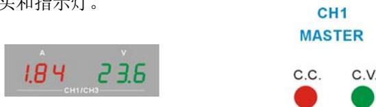
电流值：CH1(Master)的表头读值显示输出电流（CH2 电流控制必须设定在最大的位置）。
